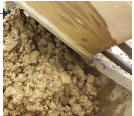
78 Texture de la terre coulée - source « Pisé H 2 O », édition CRAterre
