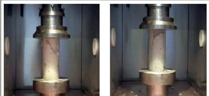
17 Essais de compression sur le béton de lin – sources : crédit photo CoDEM Picardie http://codempicardie.com/
