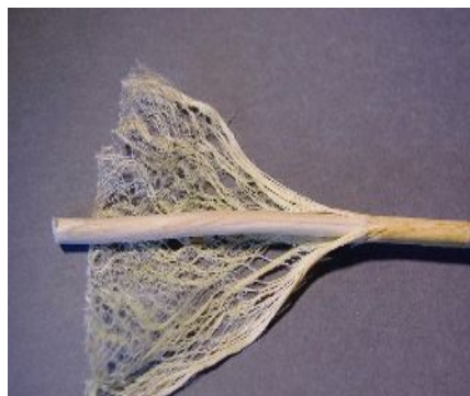
3 Séparation de la filasse et de la chènevotte – source www.lavantage.qc.ca
